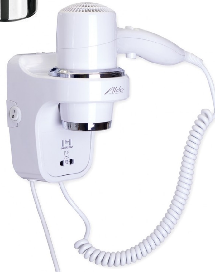
Pistolový fén opatřený zásuvkou na holící strojek, centrálním vypínačem zvyšující bezpečnost a mžikovým spínačem. Napájení je možné kabelem se zástrčkou nebo lze fén zapojit přímo na pevný přívod. Má dvě rychlosti pro teplý vzduch a jednu rychlost pro studený vzduch. Rozměry (v x š x h): 235x115x147 mm. Příkon: 200 W studený/900/1800 W. Barva: bílá / chrom. El. zásuvka : 240/110 V (0,05/0,1 A)
