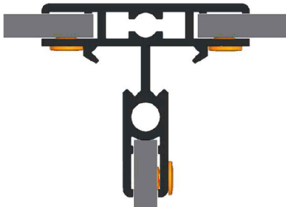
Detail půdorysu zadního hliníkového profilu (T)
