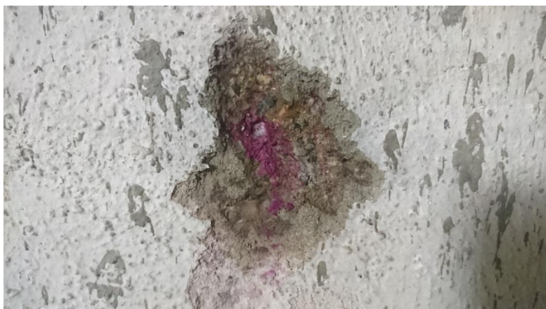
Obrázek 6: Zkouška karbonatace – zdravý beton po odbourání cca 1 cm betonu
