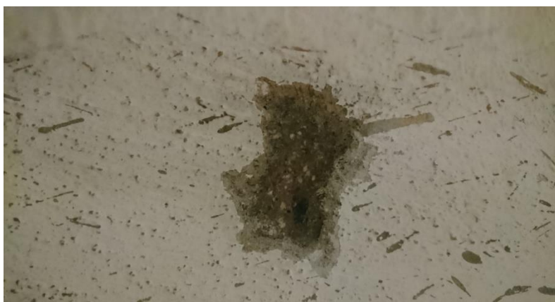
Obrázek 5: Zkouška karbonatace – poškozený beton
